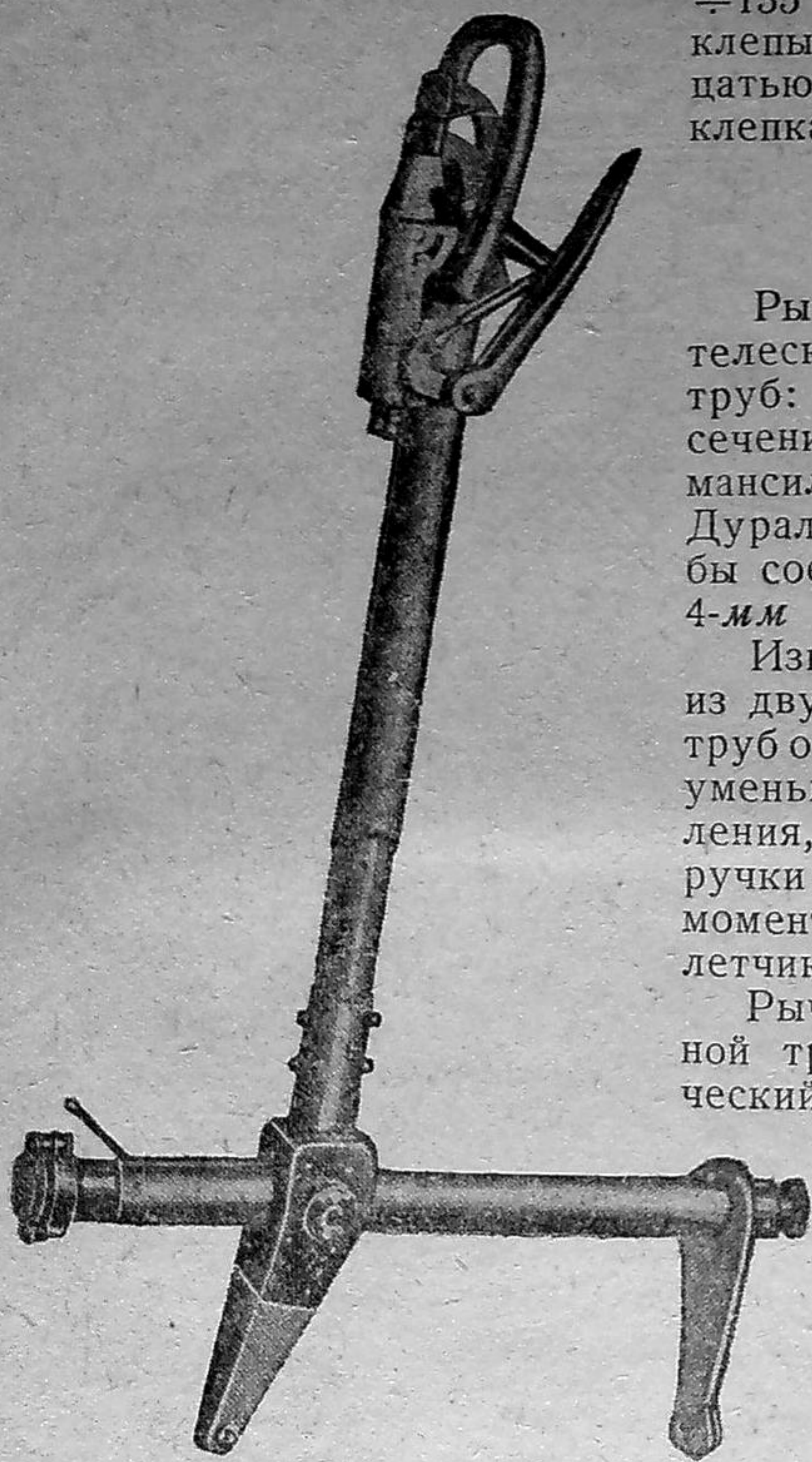
Фиг. 69. Ручка управления самолетом с продольной трубой.
